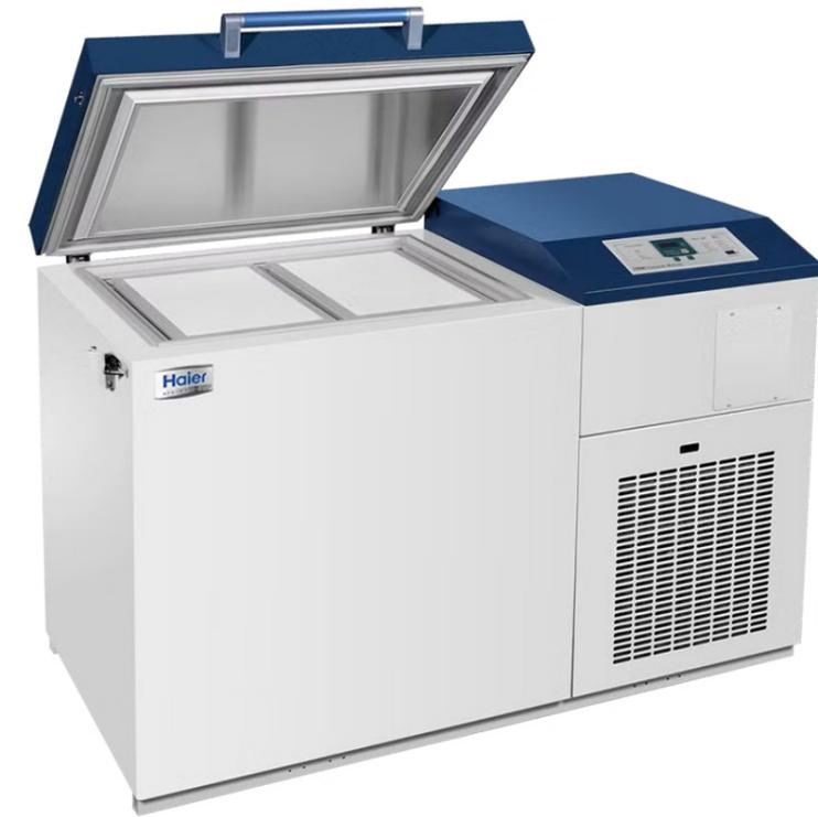
El congelador criogénico de -150 °C de Haier Biomedical, supone una alternativa a los tanques de nitrógeno líquido para un almacenamiento en seco de muestras. Este sistema es seguro, conveniente y económico.
